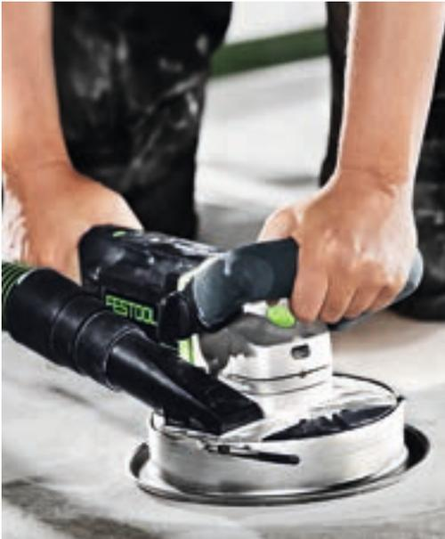
**Rápido avance en el trabajo:** la saneadora de diamante RENOFIX RG 130 E para un rápido arranque de material como hormigón, solado y restos de adhesivo en grandes superficies.
