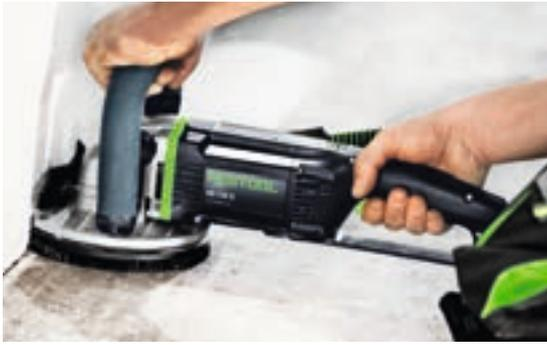
**Trabajo cerca de los bordes:** con el segmento plegable de la saneadora de diamante RENOFIX RG 130 E se puede lijar hasta la pared.
