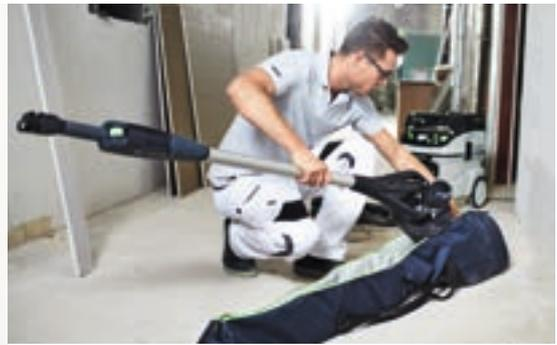
**Resultados increíblemente precisos:** Lijadora de pared PLANEX easy y sistema móvil especial de aspiración con AutoClean. Trabaje sin fatiga y con gran comodidad gracias al reducido peso de la máquina de tan solo 4 kg y a la cómoda distribución del peso.
