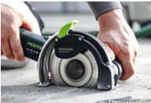
**Cortar sin polvo fácilmente:** El sistema de corte a mano alzada DSC-FH es la combinación ideal de amoladora angular precisa y de fácil manejo junto con una aspiración de polvo eficiente: la caperuza de aspiración absorbe el polvo allí donde se genera. Y se puede abrir para hacer cortes cerca de los bordes.
