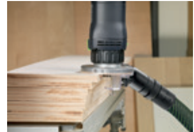
Fresado a bisel para cantos de encolado en plástico y madera maciza.
