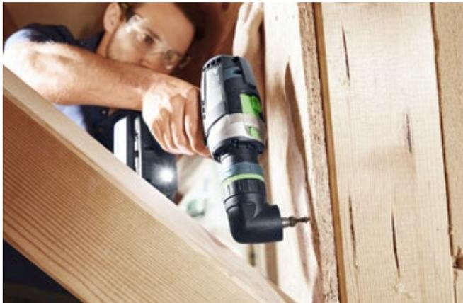
**Atornillado en esquinas.** El ángulo adicional tiene su fuerte en la perforación o el atornillado en espacios angostos. Y es literalmente fuerte incluso con pares de giro importantes.
