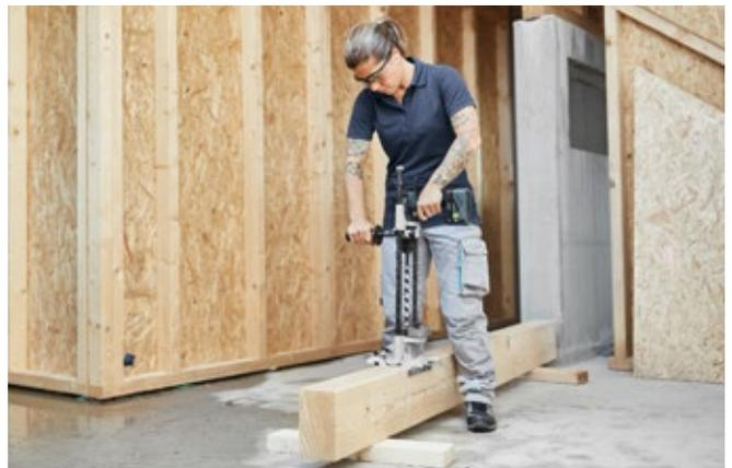
**Portabrocas de sujeción rápida.** El portabrocas de cierre rápido se coloca en la máquina sin herramientas y se aprieta a mano. Con un margen de sujeción de 1,5 a 13 mm, se pueden realizar trabajos de perforación extremos.
