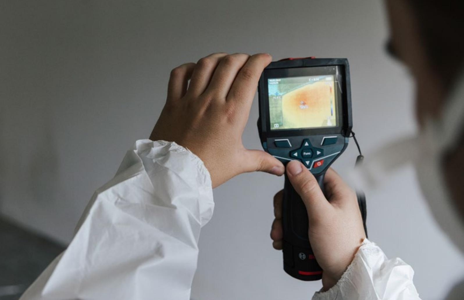
↑ En la pantalla de la cámara térmica puede verse la propagación del moho.
