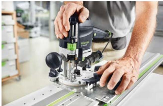
**Orificios en serie.** La OF 1010 R y el sistema de perforación en línea LR 32 permiten realizar series de orificios para soportes de estantes, retenedores de paneles o herrajes de forma sencilla, rápida y eficiente.
