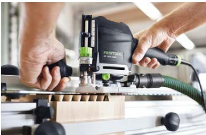
**Tradicional pero racional.** En combinación con el sistema de ensamblaje VS 600, puede trabajar con perfección artesanal de máximo nivel, p. ej., en tareas de ensamblaje de espigas rectas o uniones exactas de cola de milano o de tacos.
