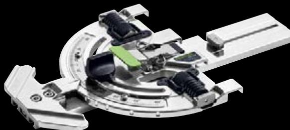
El nuevo tope angular regulable con ajuste fino se acopla fácilmente al riel de guía mediante la palanca de sujeción y permite realizar cortes angulares precisos y fiables de entre  $-60^\circ$  y  $+60^\circ$ .
