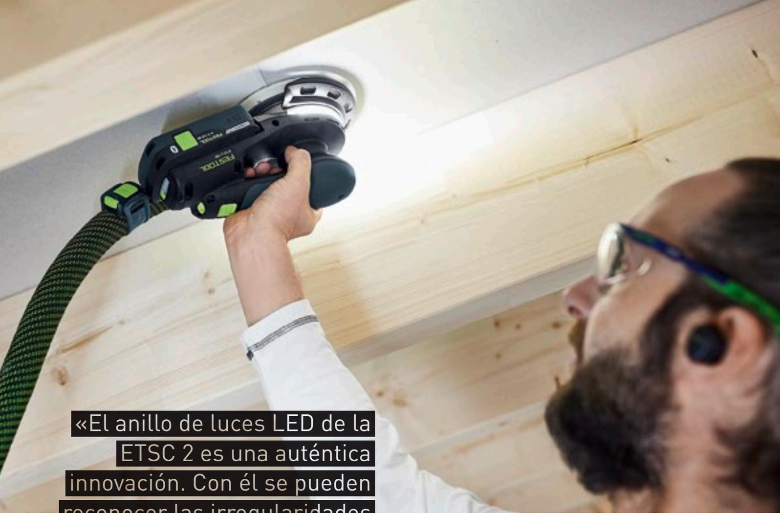
«El anillo de luces LED de la ETSC 2 es una auténtica innovación. Con él se pueden reconocer las irregularidades durante el lijado y evitar un repaso innecesario».
