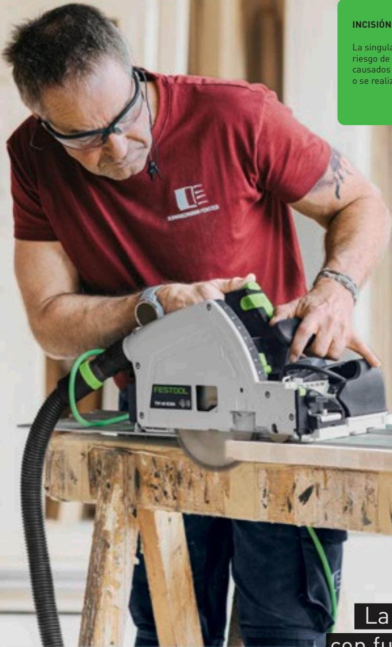
La sierra de incisión con función de precorte TSV 60 K de Festool muestra así claras ventajas, tanto en el corte de madera como con materiales más modernos. El resultado: cortes sin desgarros a ambos lados en una sola pasada.
