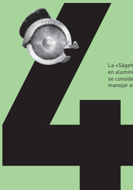
La «Sägehexe» AAU 50 de 1953 estaba fabricada en aluminio fundido y, con solo **4 kg** de peso, se consideraba especialmente ligera y fácil de manejar en la década de 1950.
