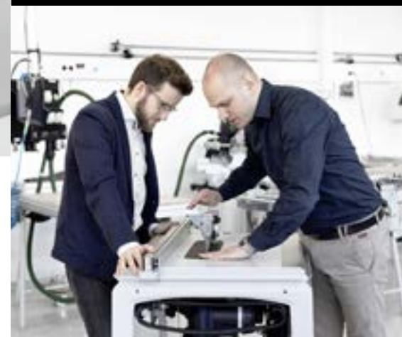
↑ Los desarrolladores Matthias Kübeler y Andreas Sdrzallek probando la nueva sierra de mesa TKS 80 con la innovadora tecnología SawStop.
